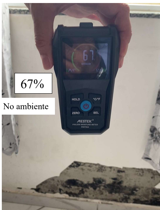
Fotos 12 e 13: Ensaio com medidor de umidade, atestando presença de umidade na parede. Sala de estar. Fonte: Perito
