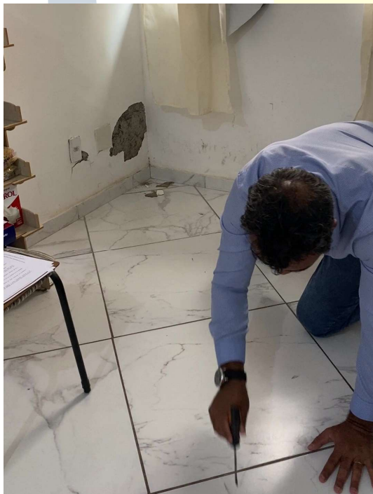
Fotos 10 e 11: Ensaio percussivo. Revestimento cerâmico apresentando som cavo (oco), anomalia na aderência. Sala de estar. Fonte: Perito
