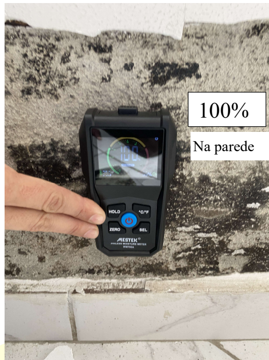
Fotos 12 e 13: Ensaio com medidor de umidade, atestando presença de umidade na parede. Sala de estar. Fonte: Perito
